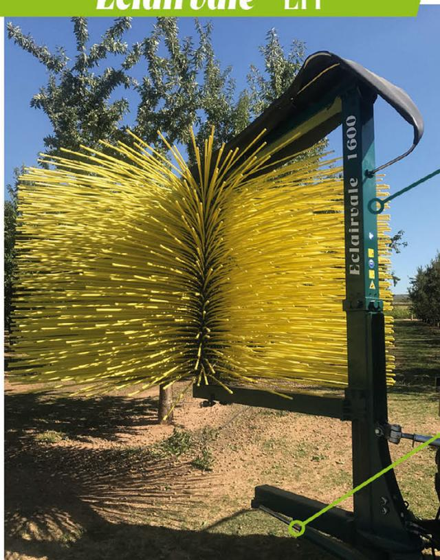
En el modelo EH, un cilindro situado en el soporte vertical permite **trabajar en árboles de 5 metros de altura** o actuar exclusivamente en la **parte superior de la huerta**.
